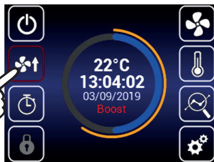
De BOOST-modus wordt geactiveerd door op het symbool in de afbeelding te drukken. De BOOST-modus wordt weergegeven in het veld ventilatiemodus
