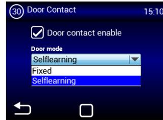
Selflearning- disponible uniquement en mode automatisé et en mode de fonctionnement actif (Auto speed control) ; optimise la durée de fonctionnement du rideau d'air en fonction du nombre de portes ouvertes, même lorsque les portes sont fermées.
